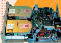
Винчестер Seagate ST-412, оснащенный двумя блинами. Общее сходство — синергисты 10 Мб. А вот физические размеры совсем не совпадают.
