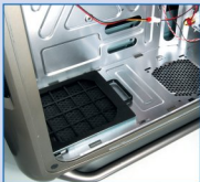
Блок питания в Cosmos 5 ставится внизу. Для него предусмотрен отдельный воздуховод и фильтр.
